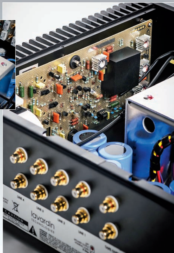
Większość tranzystorów, łącznie z końcowymi (jedna para na kanał, umieszczone po drugiej stronie płytki) ma starte oznaczenia. Uwagę zwracają charakterystyczne radiatory o dużej powierzchni emisji
