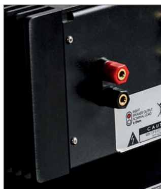
Zbyt ciasno rozmieszczone terminale głośnikowe zniechęcają do korzystania z widetek
